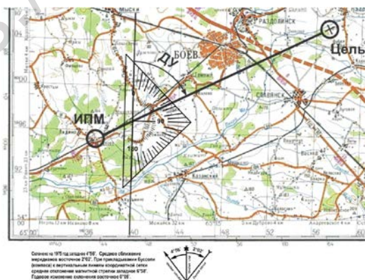
Рис. Измерение дирекционных углов на карте М 1:200000
